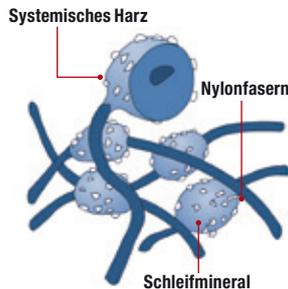
Zusätzlich passen sich Scotch-Brite™ Produkte auf Grund hoher Flexibilität und Federwirkung jedem Werkstück optimal an.
