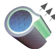
**Schälkräfte** wirken nur auf die Kante der geklebten Fläche, so dass ihnen nur eine ganz geringe Klebstoffmenge entgegenwirken kann.
