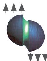
**Scherkräfte** wirken parallel zur Klebung und sind häufiger als Zugkräfte.
