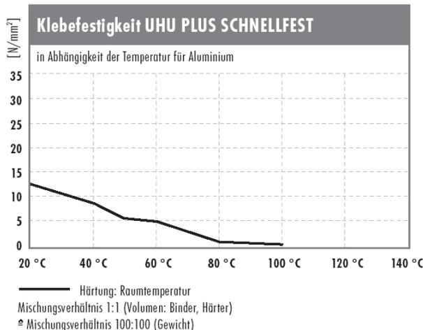
**Durchführung:** Zugscherfestigkeiten in Anlehnung an DIN 53286; vor Prüfung Lagerung 7 Tage bei 20 °C/65% relative Luftfeuchtigkeit; Zwick Prüfmaschine mit Temperierkammer (Prüfgeschwindigkeit: 50mm/min)
