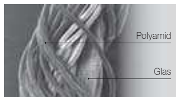
Guter Aufbau. Kern – Mantel – Garn.
